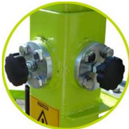
Discos nylon ajustables en el chasis para impedir vibraciones.
